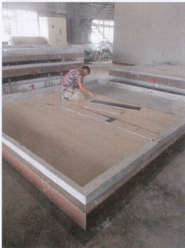
照片 3 試驗件組裝過程(鋪設 SPC 地板)
